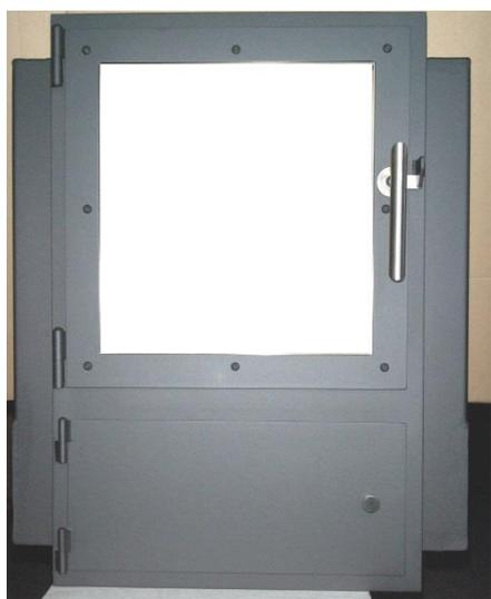
Heiztüre mit Glas, unten angebaute Aschentüre mit Aschenfallklappe, Raumlufunabhängige Verbrennungslufführung über Türhals, inkl. Aschenschublade, Griff Chromstahl 02, (Breite Heiz- und Aschentüre 400, Höhe Heiztüre 450, Höhe Aschentüre 180, Preis Fr. 2'225.00)
